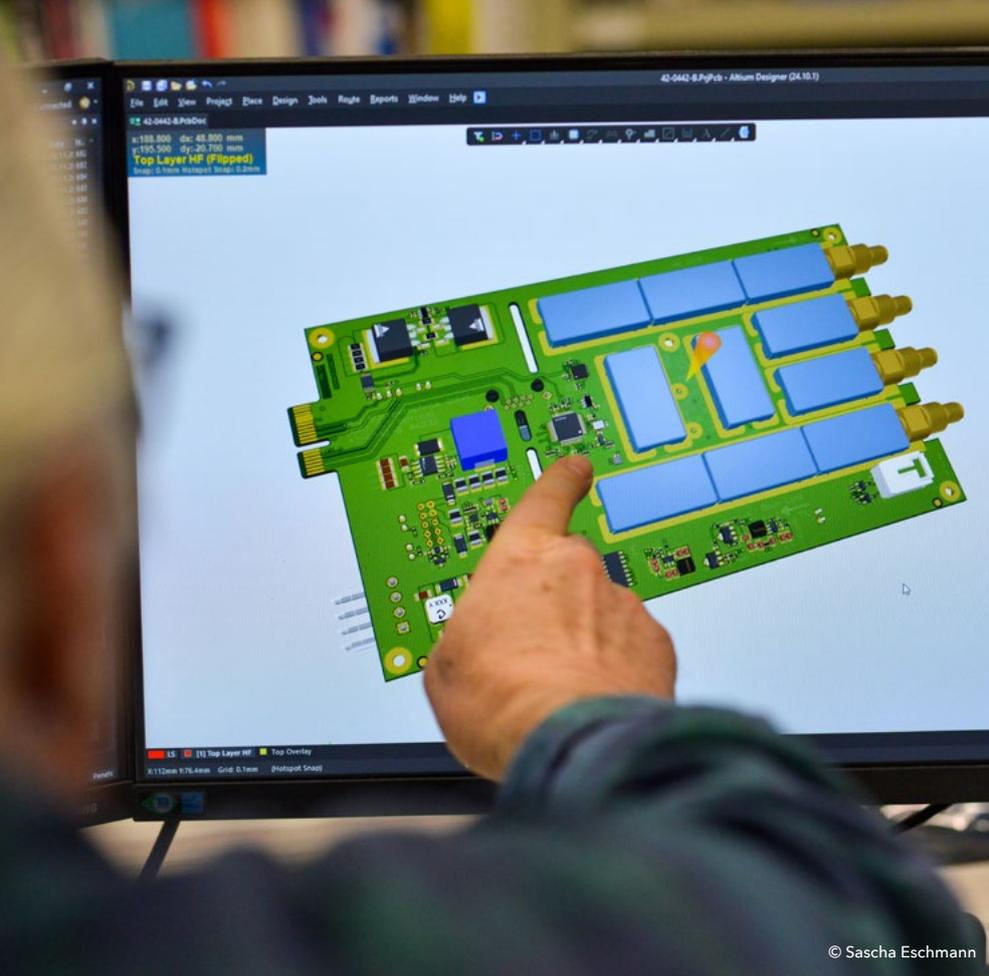
Am Rechner werden die einzelnen Bauteile für die Hardware entworfen, wie hier am Beispiel eines Platinen-Designs zu sehen ist.
